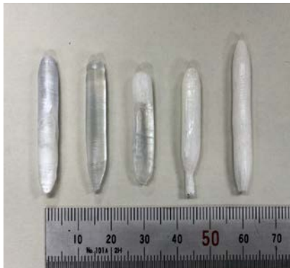
図2 光FZ法で育成した Ga_2O_3-Al_2O_3 系結晶
