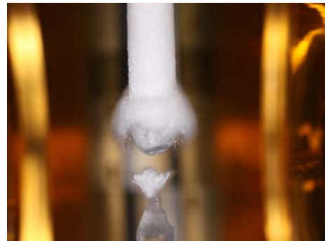
図4 Ar雰囲気中の加熱で Ga_2O_3-Al_2O_3 原料棒上に形成された綿状の物質
