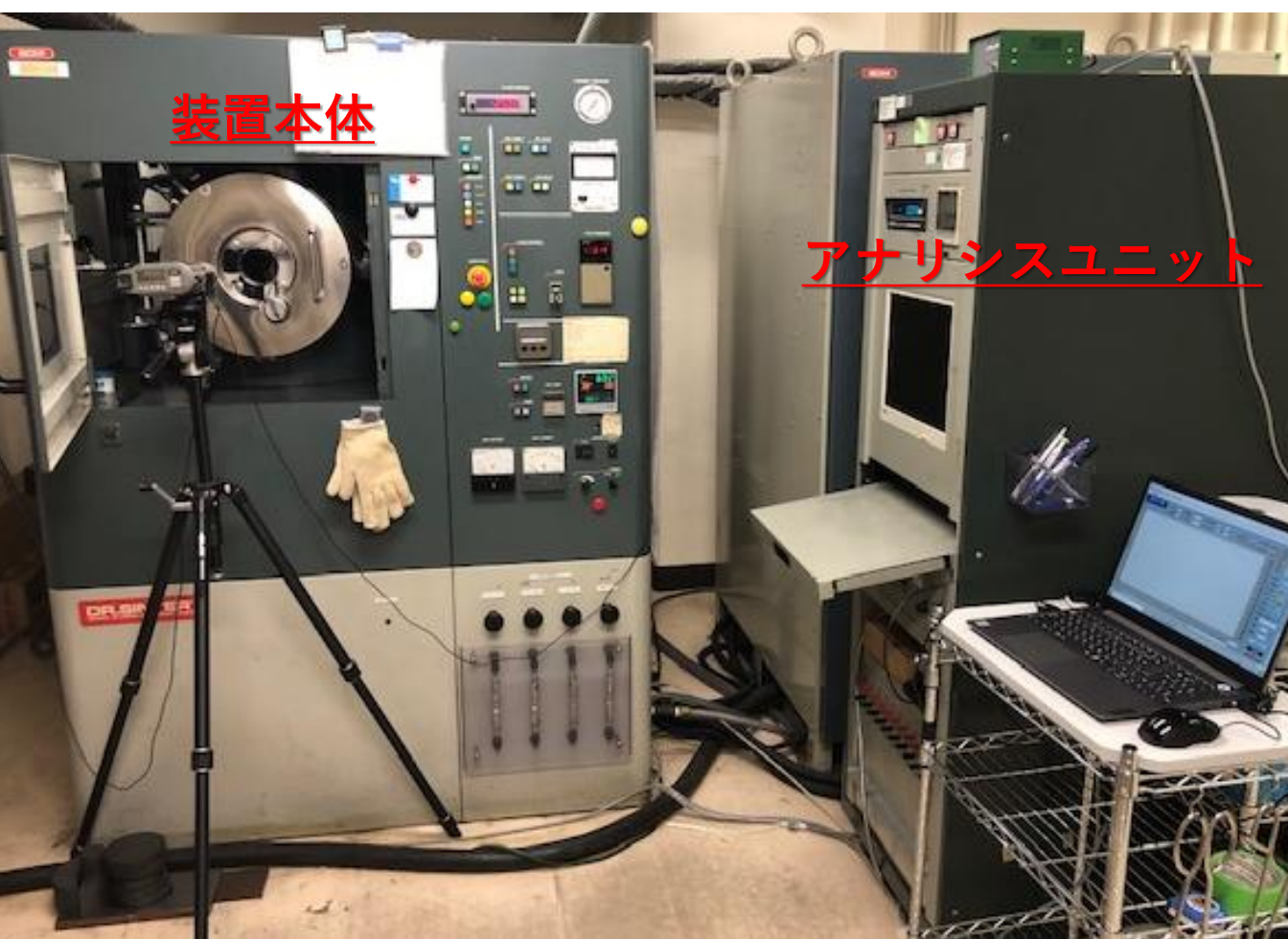
【放電プラズマ焼結装置 SPS-1050】 住友石炭鉱業株式会社製
