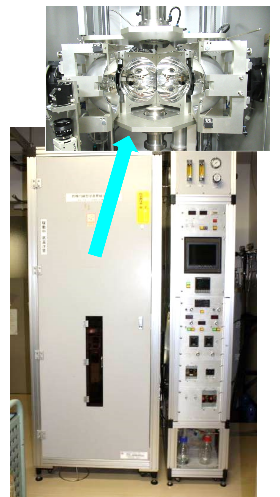
写真2 四楕円鏡型浮遊帯域溶融装置
