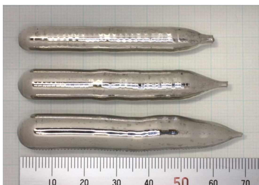
図3 作製したFe-32Ni単結晶
