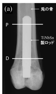
図4 白色家兎の大腿骨にインプラントした陽極酸化TiNbSn合金 (a) と、ロッド引抜強度の飼育期間依存性 (b)
