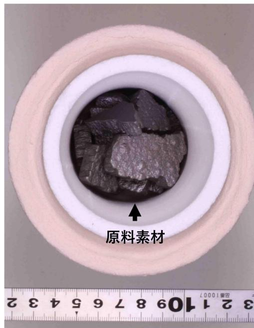
写真3 二重るつぼに充填した原料
