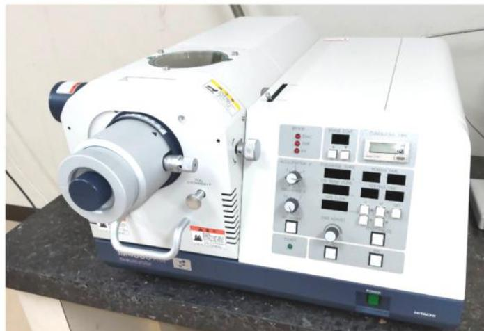
図. イオンミリング装置（日立ハイテク, IM400PLUS）
