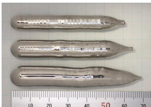
同口径の棒材から、上軸側 (原料棒) 移動速度を下軸側移動速度 (育成速度) より速くすることで、単結晶の口径を太くでき、口径制御が可能となる。
