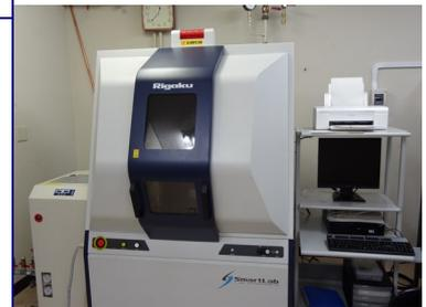
**2-12 高輝度 X 線微小単結晶構造解析装置**
