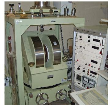
**2-16 背面反射デジタル CCD ラウエカメラ**
