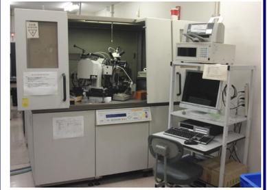
**2-14 高輝度 X 線粉末構造解析装置**
