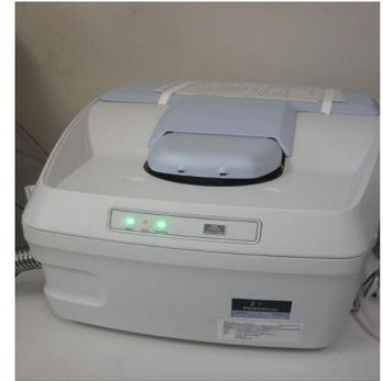
**2-10 汎用型熱分析測定システム (DTA,DSC,TMA)**
