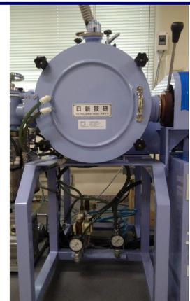
**3-9 超高温浮遊溶融型複合セラミックス作製装置**
