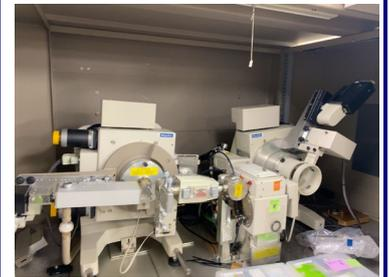
**2-15 温度可変磁化測定装置 (VSM)**
