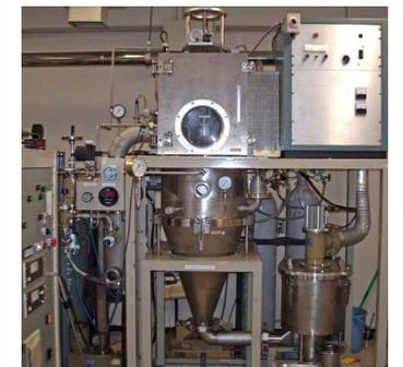
**1-12 高周波溶解式傾角鑄造装置**
