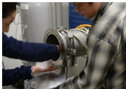
メルトスパンで作製した試料を取り出すところ
