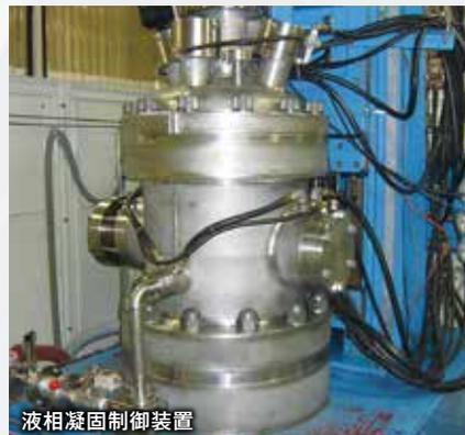
液相凝固制御装置
