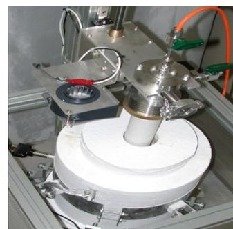
**3-13  $\mu$ -PD 結晶作製装置**
