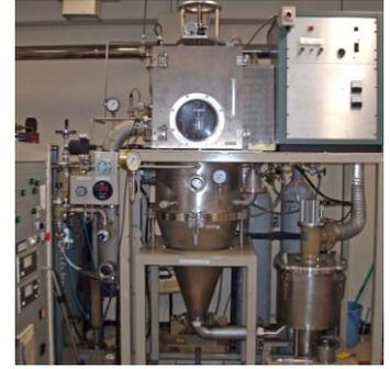
**1-10 高周波溶解式傾角鑄造装置**
