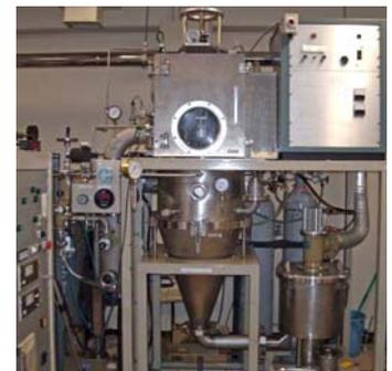
**1-12 高周波溶解式傾角鑄造装置**
