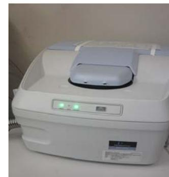
**2-11 汎用型熱分析測定システム (DTA,DSC,TMA)**
