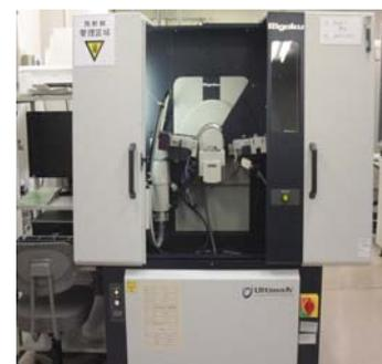
**2-3 試料水平式エックス線回折装置**
