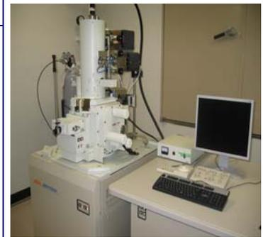
**2-6 フィールドエミッション電子プローブマイクロアナライザー (FE-EPMA)**
